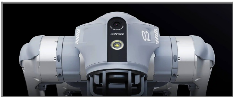
Сурет 5. – Робот иттің қашықтан бақылау үшін пайдалы жүктемесі: лидар, видеокамера, термовизор және жарықдиодты прожектор
