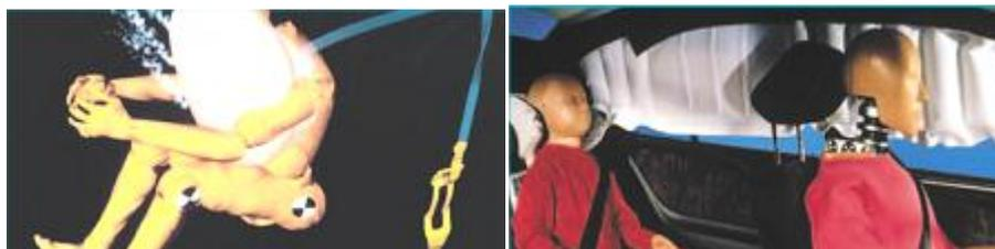
**Рисунок 1. Срабатывание подушек безопасности (передней и подушек типа «шторки»)**
