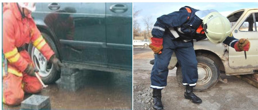
**Рисунок 7. Стабилизация автомобиля (установка проставок и прокалывание колес для надежной посадки машины на них и максимального обездвиживания ТС)**
