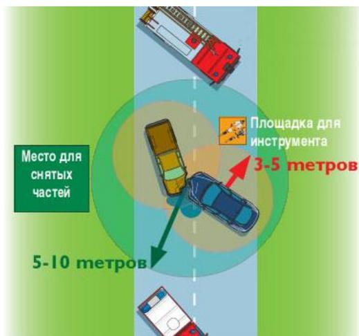
**Рисунок 5. Подготовка рабочих зон и размещение машин экстренных служб на месте аварии**
