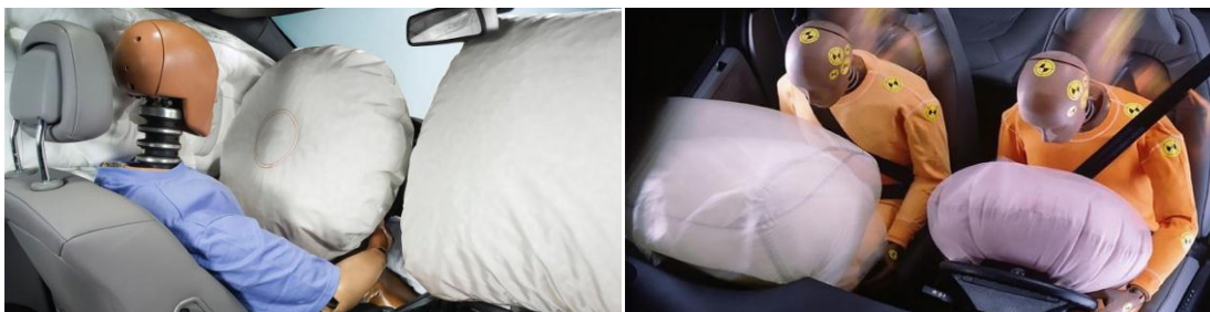
№1 сурет. Қауіпсіздік жастықшаларын іске қосу (алдыңғы және «перде» типті жастықтар)
