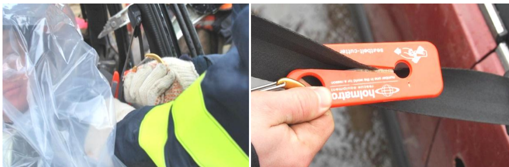
№9 сурет. Қауіпсіздік белдіктерін кесу
