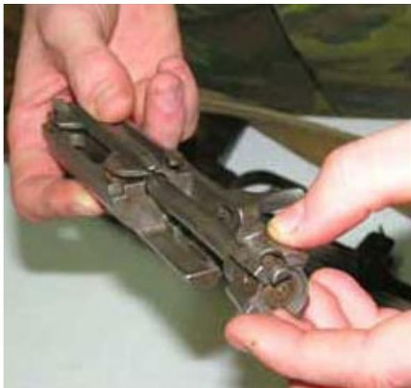
7) Отделить ударно — спусковой механизм. Повернуть предохранитель вверх до вертикального положения, сдвинуть его вправо и отделить от ствольной коробки, взявшись за спусковую скобу, движением вниз отделить ударно — спусковой механизм от ствольной коробки.
