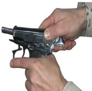
4) Снять возвратную пружину.
