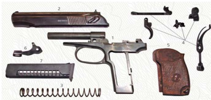
**1) Рамка со стволом и спусковой скобой** служит для соединения всех частей пистолета. Рамка с основанием рукоятки составляет одно целое.
