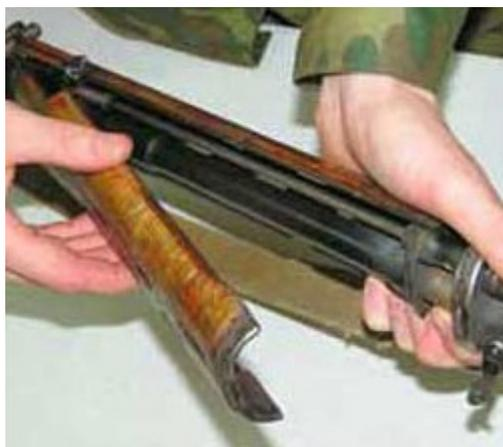
9) Отделить газовый поршень и толкатель с пружиной. Отвести толкатель назад, вывести его передний конец из гнезда поршня и отделить от газовой трубки поршень, ввести передний конец толкателя в газовую трубку, поджать пружину толкателя до выхода ее из канала прицельной колодки и отделить толкатель с пружиной, а затем отделить пружину от толкателя.
