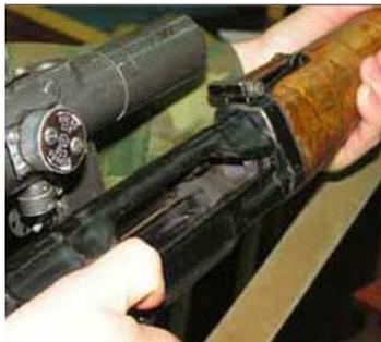
2) Отделить оптический прицел. Приподнять ручку зажимного винта и повернуть ее в сторону наглазника до отказа, двинуть прицел назад и отделить его от ствольной коробки.
