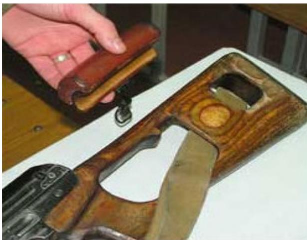
4) Отделить крышку ствольной коробки с возвратным механизмом. Повернуть замыкатель крышки ствольной коробки назад до постановки его на фиксатор; поднять вверх заднюю часть крышки ствольной коробки и отделить крышку с возвратным механизмом.
