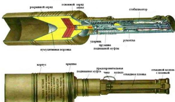
В рукоятке смонтированы стабилизатор, укрытый откидным колпаком рукоятки, и ударный механизм с
