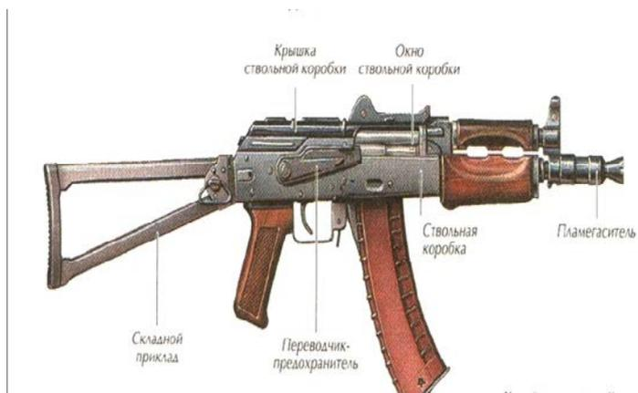
Принцип работы автоматики автомата Калашникова основан на использовании энергии пороховых газов, отводимых из канала ствола через газовую камеру к газовому поршню затворной рамы.
