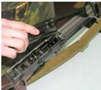
5) Отделить затворную раму с затвором. Отвести затворную раму назад до отказа, приподнять ее и отделить от ствольной коробки.
