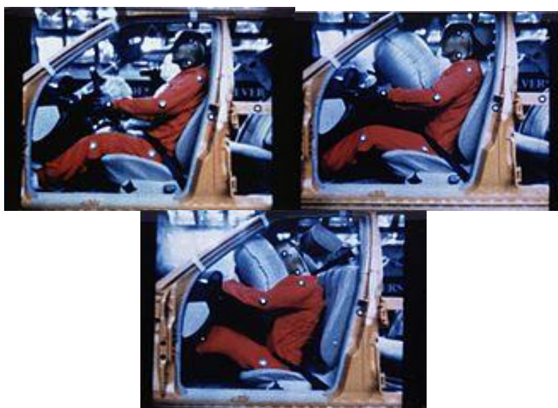
2.13-сурет. Қауіпсіздік жастығының жұмыс істеу принципі
