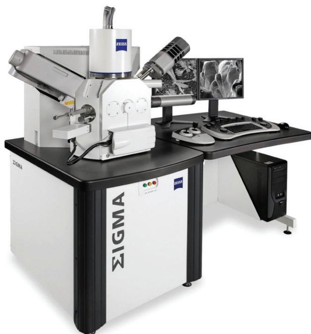
Рис. 1.11. Растровый электронный микроскоп
