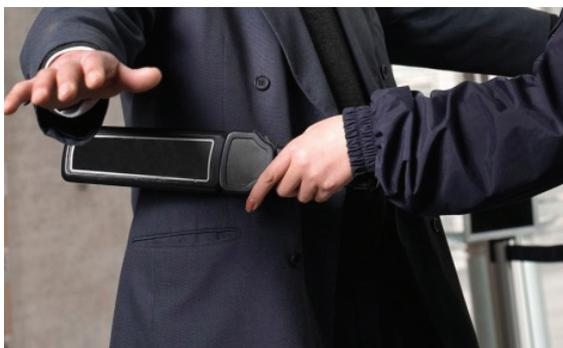
*Рис. 1.4. Портативный металлоискатель*
