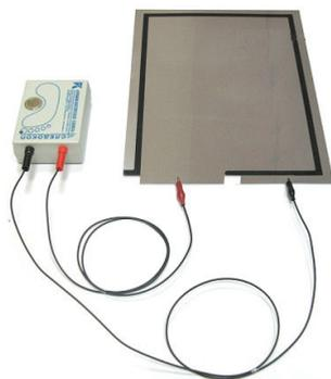
*Рис. 1.6. Прибор для изъятия пылевых следов*
