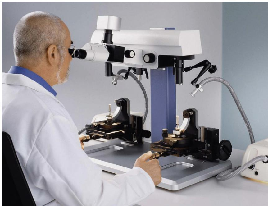
*Рис. 1.9. Сравнительный криминалистический микроскоп*
