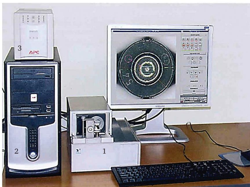
*Рис. 1.10. Автоматизированная баллистическая идентификационная система:
