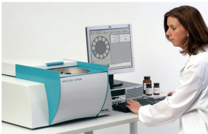
Рис. 1.13. Рентгеновский спектрометр
