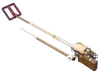
*Рис. 1.3. Переносной индукционный миноискатель ИМП-2*
