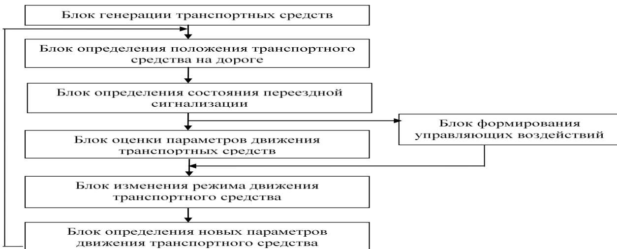
Рисунок 3. Общая схема имитационной модели для исследования параметров
