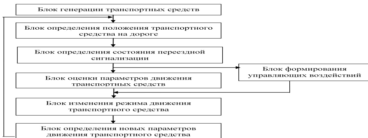
Рисунок 3. Общая схема имитационной модели для исследования параметров движения автотранспортного потока на подходе к железнодорожному переезду
