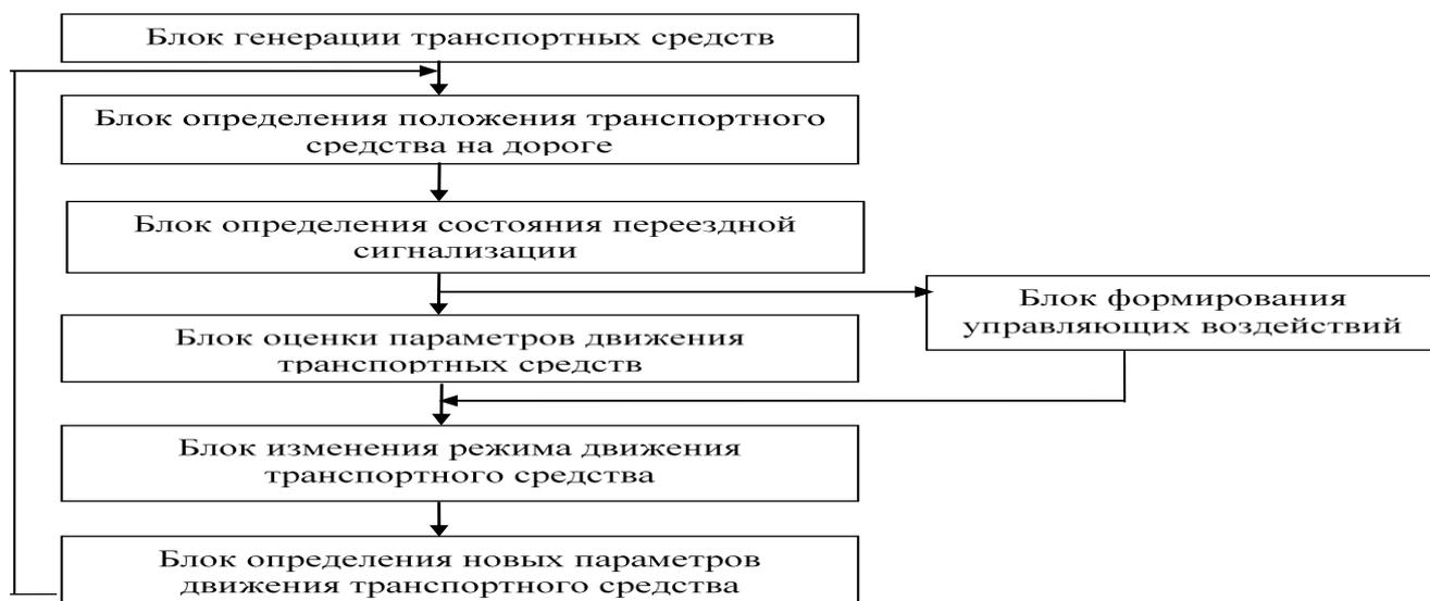
Рисунок 3. Общая схема имитационной модели для исследования параметров движения автотранспортного потока на подходе к железнодорожному переезду
